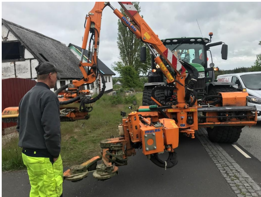
Figur 4 - Lejre Kommunes amskinel til klipning af vejkantegræs.
