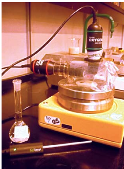
Forsøgsopstilling med CO 2 - og O 2 -elektrode, sensor-kolbe med gær-substrat opløsning, termometer samt magnetomrører
