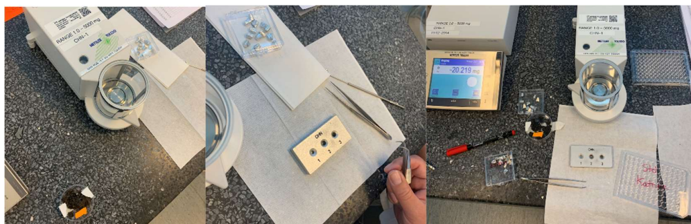
Foto 25 Afvejning af CHN-prøver i tinbægere på mellem 2,5-3,0 mg \pm 0,0005 mg. Fra venstre: Vægt af mærket "Mettler Toledo" (Range 1.0-5000 mg), tinbægere og holder til fyldning af tinbægere, afvejning af prøver i tinbægere inden pakning til kugler.
