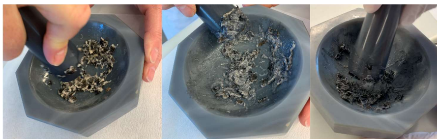
Foto 23 Mortning af larver i agat-morter. Fra venstre: mortning startes efter at larverne er klippet i tre stykker, der mottes til en jævn pasta-lignende masse, færdigmortet homogeniseret larvemasse klar til analyse.
