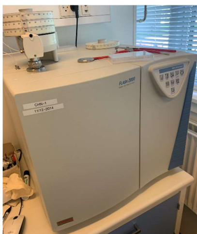
Foto 24 CHN-analysemaskinen "Flash 2000 – Organic Elemental Analyzer, NCS Analyzer" af mærket "Thermo Scientific". Maskinen afbrænder ved 950°C (sammenlignet med Dumas-metoden, som afbrænder ved 900°C)
