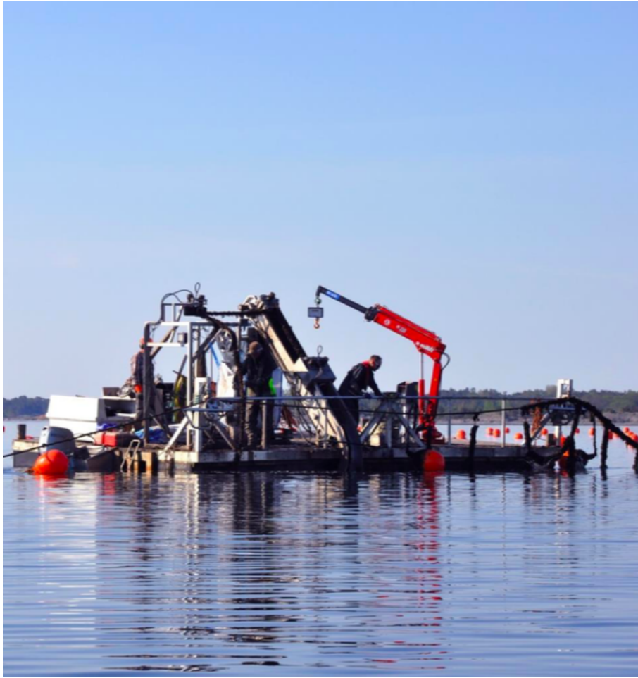
Billede 19: Høst af langliner med specialbygget tømmerflåde i Sankt Anna i Sverige (SUBMARINER Network, 2019: 20, figur 19).
