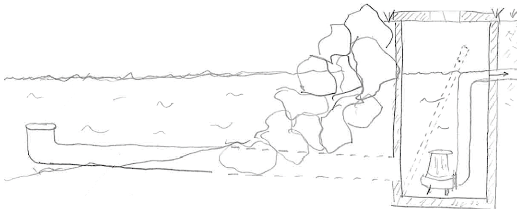
Figur 18: Skitse af indpumpningen for det landbaserede forsøgsopdræt. Illustreret af Peter Birk.
