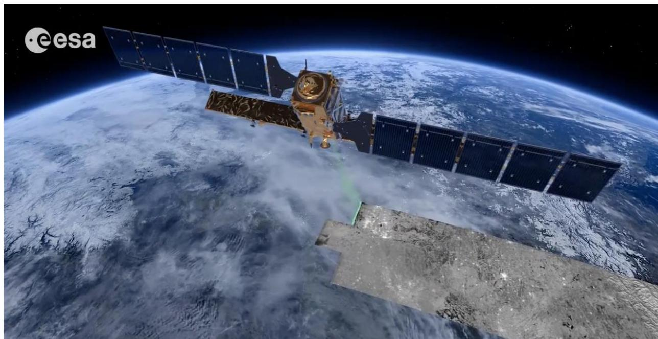
Figur 8 - (ESA.int, Sentinel-1, Satellite Constellation, u.d.)- Sentinel-1 scanner med radar et område med bredden af sub-swath 3 gange for at få den fulde swath bredde.
