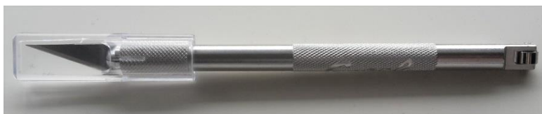
Figur 22 Skalpel med lille tromle i den ene ende, der anvendtes til at tromle partikler før transmittance- og transflectance -måling
