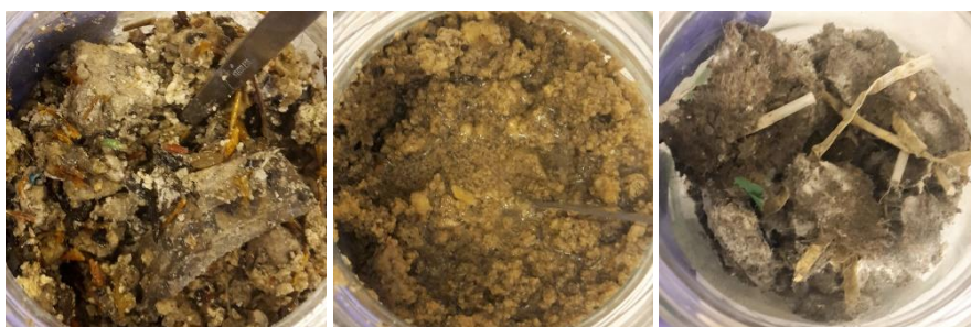
Figur 11 A) Fedtprøve FED fra 16.6.16, der er meget heterogen ift. B) fedtprøve FED2 fra 27.9.16. C) Fast stof fra strainpressen SPF, der er tørre hårklumper med synligt makroplast.
