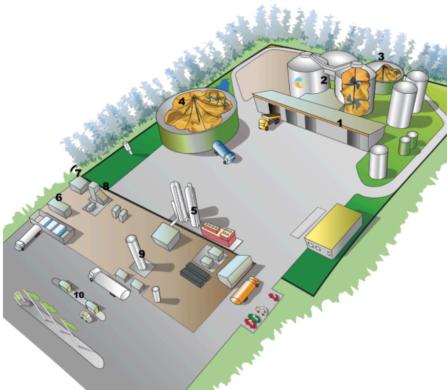
Figur 43: Oversigt over Lidköping biogas. Produktionen består af 70 procent LBG & 30 procent CBG. (Lidköping biogas 2015: 8)
