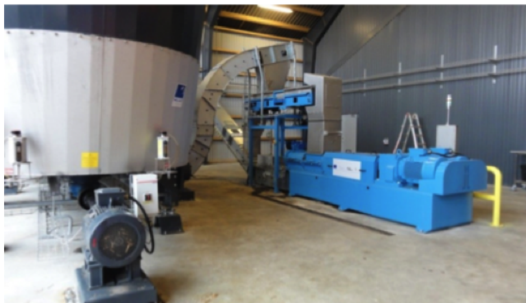
Mikseren til venstre føder den oprevne biomasse ind i ekstruderen (blå), hvorfra den føres videre til reaktor tanken (til højre).
