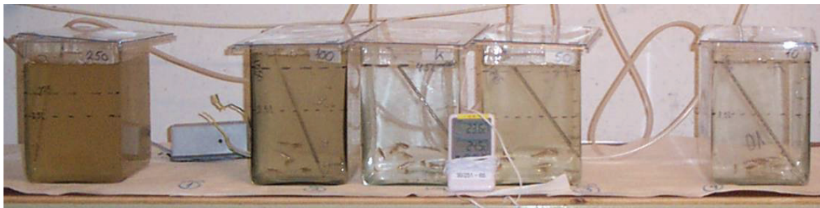
Figur 23. Forsøgsopstilling på DHI, som viser akvarierne med forskellige koncentrationer af hospitalsspildevand. Der fremkom kraftig slimdannelse allerede efter 12 timer, hvilket gjorde det vanskeligt at se fiskene.
