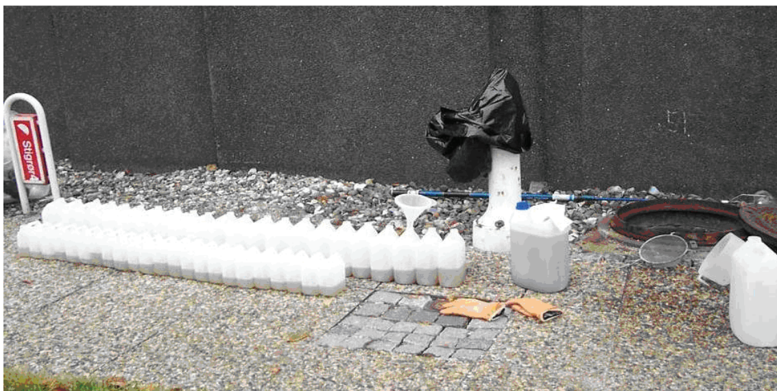
Figur 13. Prøveindsamling fra brønd S1 ved center 4. Opblandingen foregik ved at udtage 2 liter ad gangen, ophælde til 10 liters dunk, ryste grundigt og derefter fordele jævnt ud på mindre dunke ad flere omgange.
