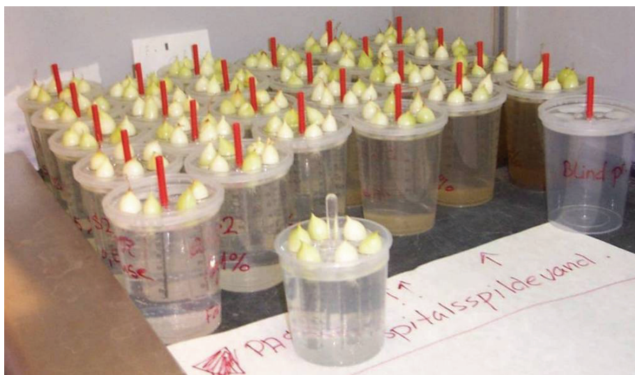
Figur 14. Her ses eksposering af løg i forskellige koncentrationer af hospitalsspildevand. Der eksposeres 6 løg pr. koncentration. Billedet stammer fra testudførelsen på RUC.
