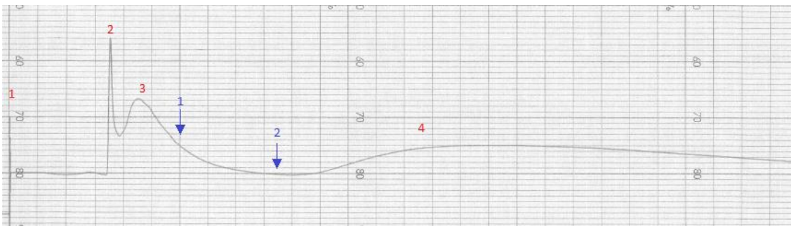
Figur 3.13: Her ses en kørsel af P85 på den semi-præparative kolonne. Hver lodret streg svarer til to minutter. 1) prøven sprøjtes på kolonnen. 2) methanol ubalancen identificeres ved en skarp peak. 3) fronten kommer ud kort efter og skylles helt ud. 4) main begynder langsomt at komme ud efter 22 minutter og er stadig ikke kommet ud efter yderligere 34 minutter. Ved opsamling sprøjtes ren methanol på ved 1, hvilket trækker main med sig ud ved 2.
