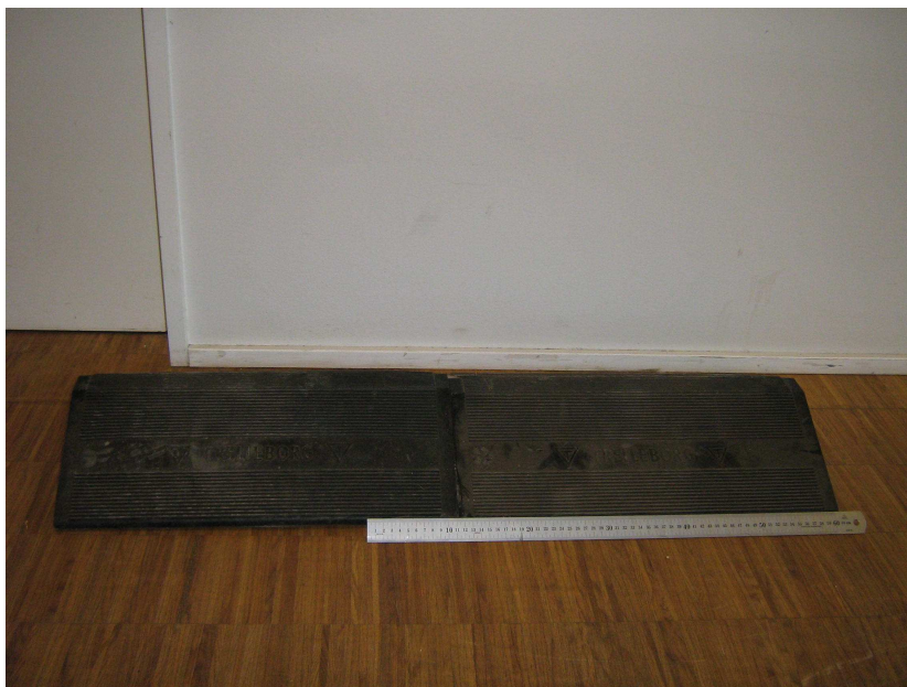
Figure A.6: Fotografi af kabelgennemføring af gummi til forebyggelse af faldskader. Stållinealen er 60cm lang.
