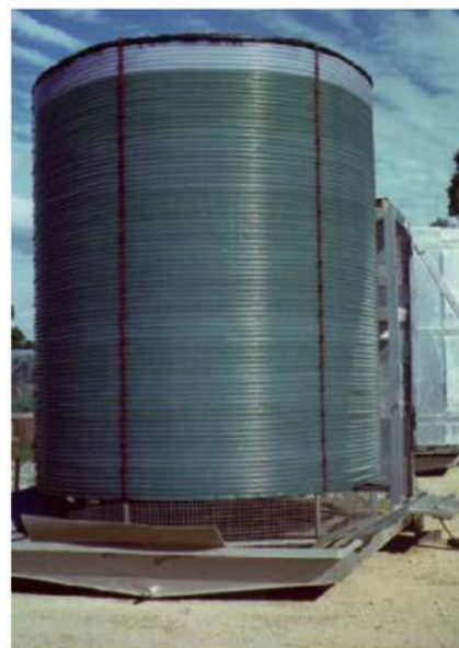
Figur 4. 1000 L helical Tubular Fotobioreaktor. (Chisti, Y. 2007 s. 298)
