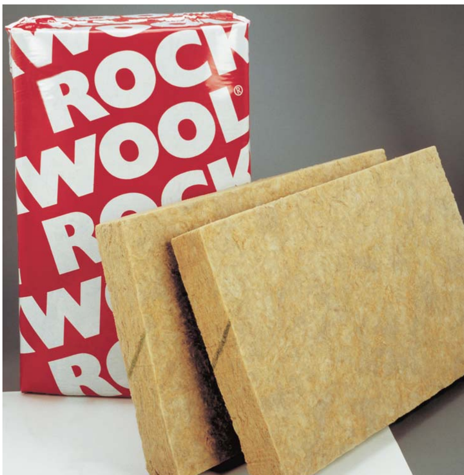
11. Isoleringsmaterialet Rockwool er faktisk i glasfasen. Det fremstilles af smeltede sten der afkøles meget hurtigt som tynde tråde. (Rockwool)
